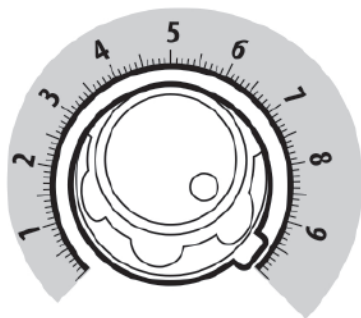
Рис. 8.6.1. Дожигание сварочной проволоки.
