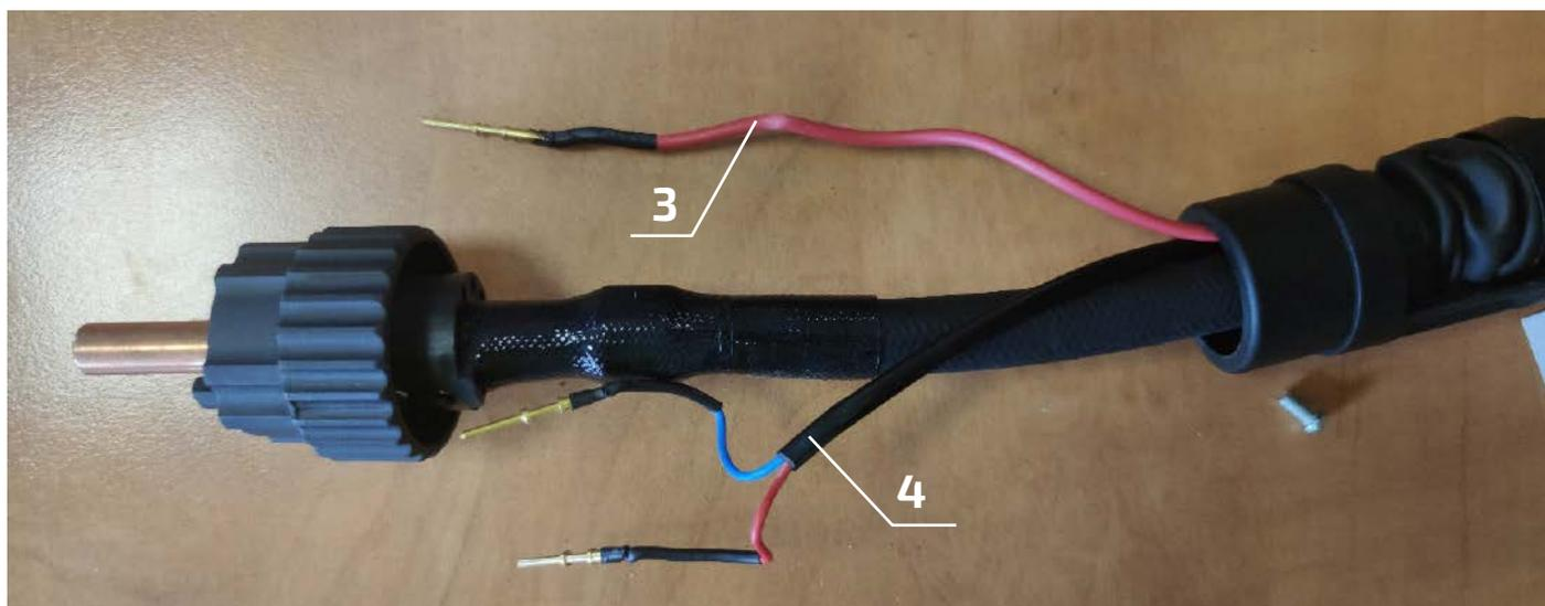
3. Снять изоляционную трубку, чтобы получить доступ к резьбовому соединению.
