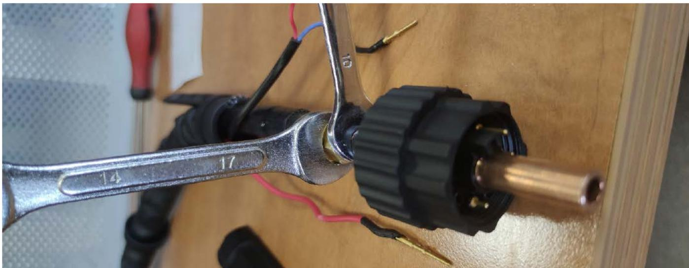
5. Установить переходник: 5 – переходник (1/4-3/8, IZT5678, арт. 00000088199), 6 – подключение проводов управления к разъему 2-pin, 7 – пайка соответствующего установочного диаметра к проводу дежурной дуги.
