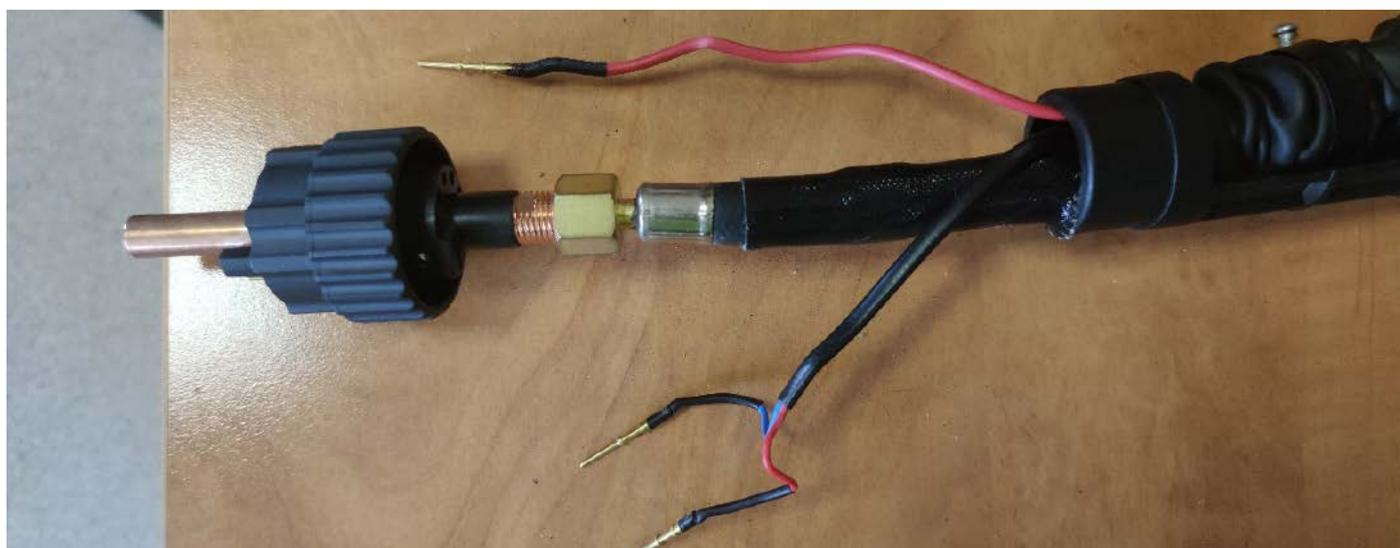
4. При помощи ключей открутить накладную гайку шлейфа от разъема.
